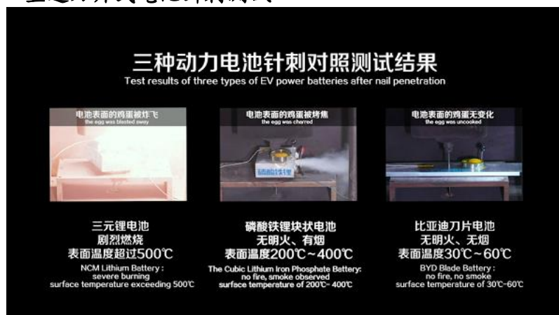
圖示 5：亞迪刀片式電池針刺測試
